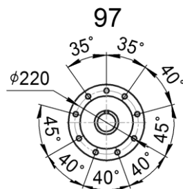
РАЗМЕРЫ ЦИЛИНДРИЧЕСКОГО ВЫХОДНОГО ВАЛА F, FF
