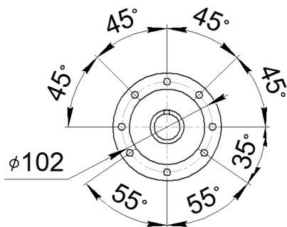
**РАЗМЕРЫ ЦИЛИНДРИЧЕСКОГО ВЫХОДНОГО ВАЛА
