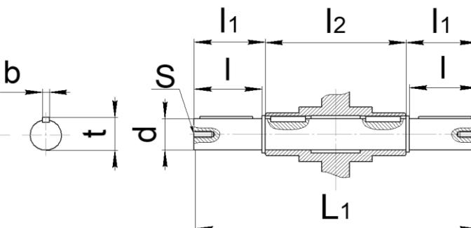
Двусторонний выходной вал
